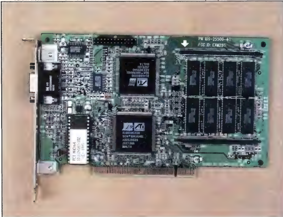
Obiekt westchnień wielu komputerowców – karta ATI mach64 Win Turbo z 2 MB pamięci VRAM
